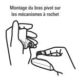
**REMARQUE**: Les mécanismes à rochet sont clavetés. Assurez-vous que les dents carrées de chaque mécanisme à rochet s'imbriquent dans celles du joint d'articulation du transducteur et que les dents triangulaires font face vers l'extérieur.
