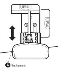
**Inclinaison vers le bas** : Il existe une déclivité naturelle de 4 à 5 degrés du bord d'attaque au bord de fuite du transducteur. D'un point de vue situé à l'arrière du transducteur, la ligne de joint devrait être légèrement sous le
