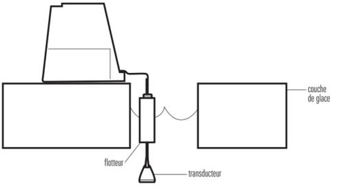
**REMARQUE** : Le transducteur doit être submergé dans l'eau pour la fiabilité de la détection. La partie inférieure du transducteur doit être à niveau avec le dessous de la couche de glace ou pendre légèrement en dessous du fond de la couche de glace.
