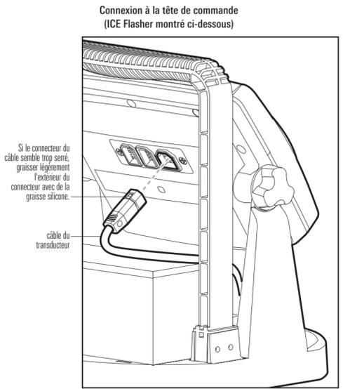
**REMARQUE** : Si un ICE 55 Flasher est utilisé, retirez la tête de commande et le boîtier du sac de transport pour raccorder le câble du transducteur, puis réinstallez-la dans le sac de transport.
