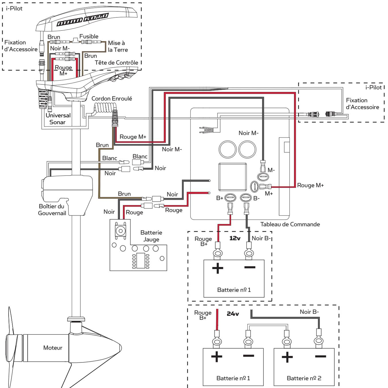
**REMARQUE:** Il s'agit d'un schéma multi-tensions. Revérifiez la tension de votre moteur afin d'effectuer les raccordements appropriés. Les dispositifs de protection contre la surintensité ne figurent pas dans cette illustration.
