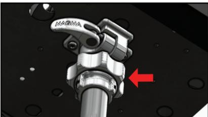
**NOTE:** To make any leveling adjustments, loosen the knob, level the grill, and then retighten the knob. | **REMARQUE :** Pour effectuer un nivellement réglages, desserrer le bouton, nivelez le gril, puis resserrez le bouton.
