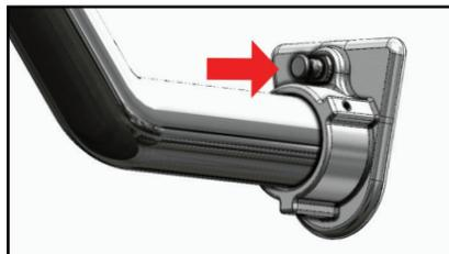
**NOTE:** To remove the arm from the receiver bracket, pull the pin at the top to release the arm and pull the arm up. | **REMARQUE :** pour retirer le bras de le support du récepteur, tirez sur la goupille en haut pour libérer le bras et tirer le bras vers le haut
