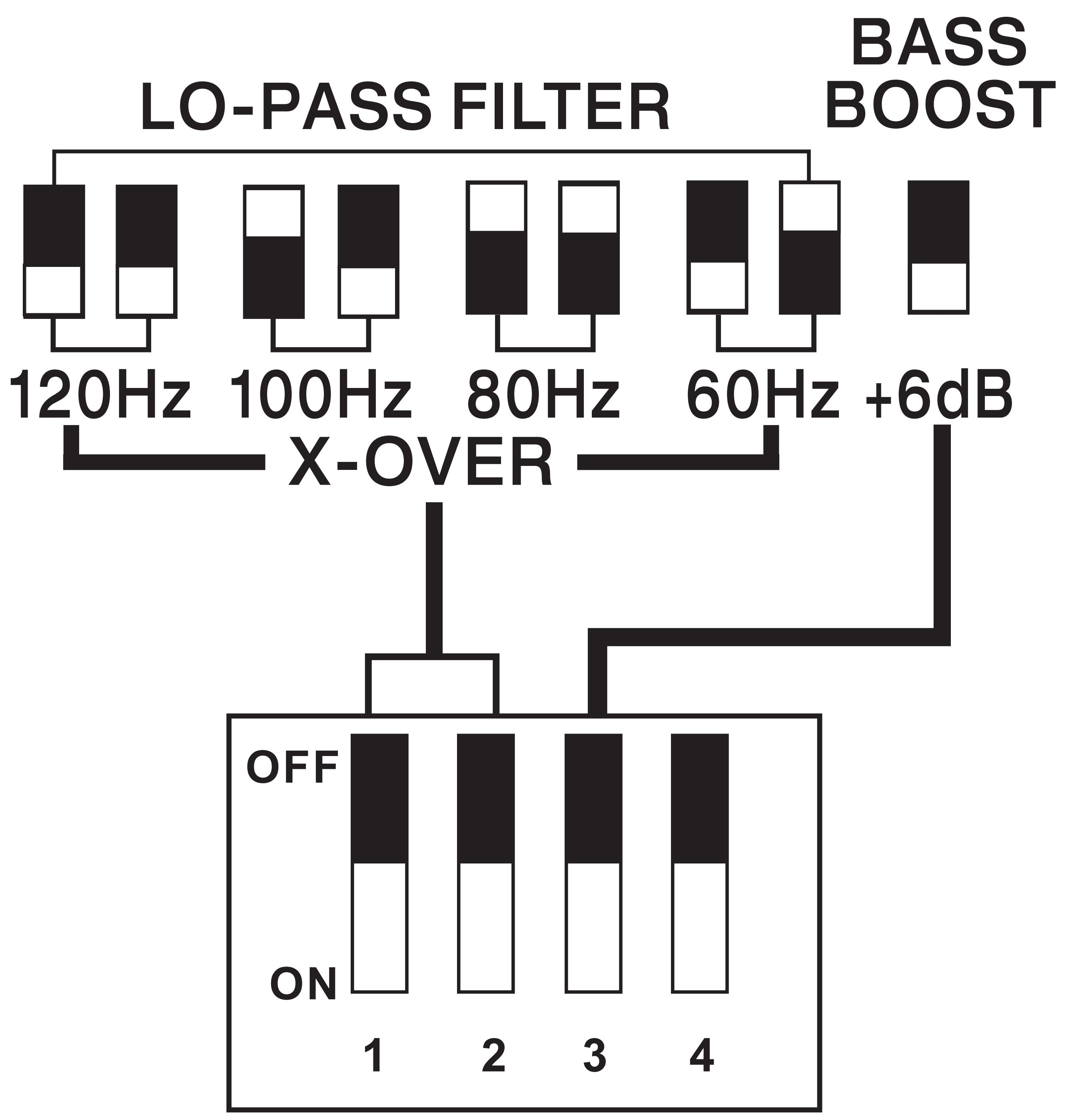
**Refuerzo de graves KICK EQ:** El refuerzo de graves está diseñado para ofrecerle mayor salida, +6dB, a 40Hz. Si lo enciende, debe reajustar el control de ganancia de entrada para evitar sobremodular el amplificador.
