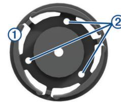
2 Используя поворотное основание в качестве трафарета, разметьте расположение направляющих отверстий ②.
