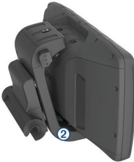
3 Kallista laitetta taaksepäin, kunnes se napsahtaa paikalleen.
